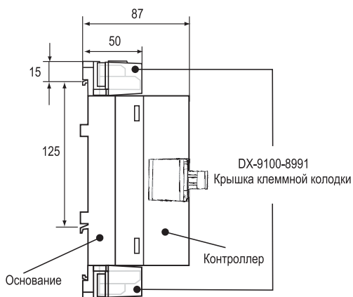
Контроллер DX-9100-8004 «Черный Ящик», Размеры в мм
